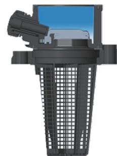
Quando a pressão da água entra no corpo da válvula através da tela do filtro, a força atua sobre a aba da válvula, fazendo com que a válvula de fundo se abra. Quanto maior a pressão, mais o disco da válvula se abre até a posição máxima, e o fluxo de água atinge o máximo. Quando a pressão da água é reduzida a zero, a aba da válvula é automaticamente fechada para evitar o refluxo da água.
